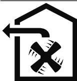
Luft skal ikke ledes til rør som brukes til avgassene fra apparater som forbrenner gass eller andre brennstoffer (dette gjelder ikke ved sirkulasjonsdrift).
