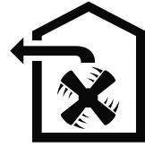
Luft skal ikke ledes til rør som brukes til avgassene fra apparater som forbrenner gass eller andre brennstoffer (dette gjelder ikke ved sirkulasjonsdrift).
