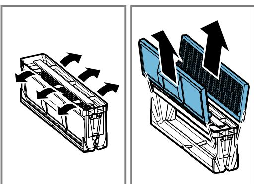
2. Sæt fedtfiltrets enkelte komponenter løst i opvaskemaskinen, de må ikke være fastklemt.
