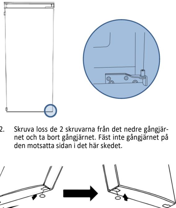
2. Skruva loss de 2 skruvarna från det nedre gångjärnet och ta bort gångjärnet. Fäst inte gångjärnet på den motsatta sidan i det här skedet.
