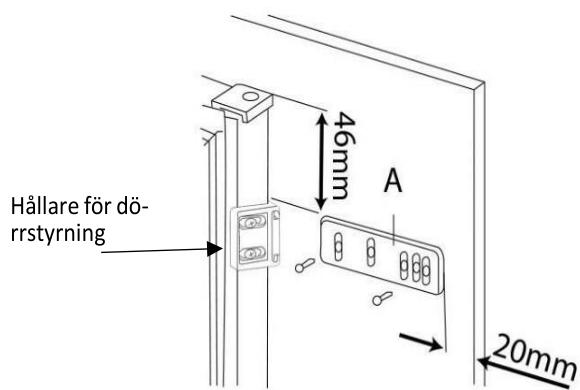
5. Om den behöver justeras använder du det fria utrymmet i dörrstyrningshållarens skruvspår på dörrstyrningen (del A).
