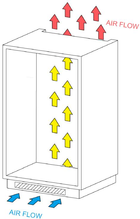
Der Schrank muss eine Lüftungsaussparung von (B)540 x (T)50mm haben.
