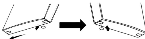
3. Fjern alle skruer dækslerne på den modsatte side af apparatet fra hvor hængslerne netop er blevet fjernet. Fjern hængsel-propperne på oversiden og undersiden af døren og sæt dem i på den modsatte side.
