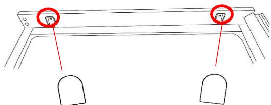
Använd en fotskyddskåpa genom att klicka fast den på fötterna i botten av apparaten. Plaststammen på fotkapslarna är till för att ge en vägledning om hur långt avståndet mellan produkten och skåpets kant ska vara (ca 42 mm). Knäpp av plaststammen efter installationen.
