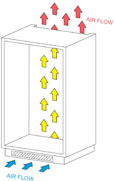
Skabet skal have et ventilationsrum på (B) 540 x (D) 50 mm.
