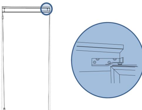
Um die Tür umzukehren, müssen Sie das Gerät nach hinten kippen, um an das untere Scharnier mit den Schrauben zu gelangen. Neigen Sie das Gerät nicht mehr als 45 Grad und legen Sie es nicht flach auf die Seite.
