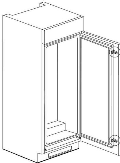
9. Es werden 2 weitere Scharnierabdeckungen mitgeliefert und diese sind für die unteren und oberen Scharniere. Diese können bei Bedarf angeklipst werden.
