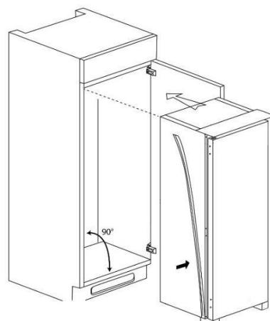
Öppna dörren och tryck den sida av apparaten utan gångjärn mot skåpväggen. Fäst apparaten på två ställen, 1) 2 torxskruvar i den övre sockeln ovanpå apparaten och 2) 2 torxskruvar i fötterna (1 i varje fot) nedanför apparaten.
