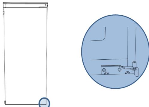
2. Lösen Sie die 2 Schrauben aus dem unteren Scharnier und entfernen Sie das Scharnier. Befestigen Sie das Scharnier zu diesem Zeitpunkt noch nicht auf der gegenüberliegenden Seite.
