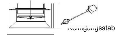
**Vorsicht: Halten Sie den Ablauf über dem Gemüse- und Obstfach immer frei, um den normalen Durchfluss von aufgetautem Wasser zu gewährleisten. Verwenden Sie die mitgelieferte Stange, um Verstopfungen zu beseitigen.**
