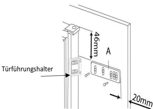
5. Wenn sie eingestellt werden muss, nutzen Sie den Freiraum in den Schraubenschlitten des Türführungshalters an der Türführung (Teil A).
