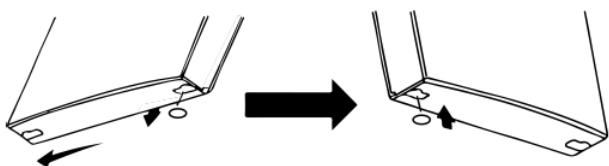
3. Ta bort alla skruvkåpor på motsatt sida av apparaten från den sida där gångjärnen just har tagits bort. Ta bort gångjärnspluggarna på dörrens övre och nedre del och fäst dem på motsatt sida.
