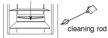
**Varning:** Håll alltid avloppet över grönsaks- och fruktfacket rent för att säkerställa det normala flödet av tinat vatten. Använd stången som tillhandahålls för att rensa eventuella blockerningar.
