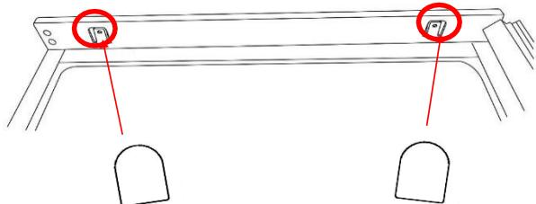
Påfør et foddæksel ved at klipse dem på plads på fodderne i bunden af apparatet. Plaststilen på fodkapperne er der som vejledning for, hvad afstanden mellem produktet og kanten af skabet skal være (ca. 42 mm). Skær plastikstangen af efter montering.
