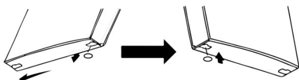
4. Drehen Sie das obere Scharnier um 180° (so dass der Stift nach oben zeigt) und befestigen Sie es auf der gegenüberliegenden Seite an der Unterseite des Geräts. Setzen Sie die Tür wieder auf das untere Scharnier.
