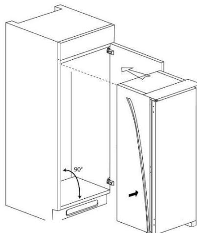
Öffnen Sie die Tür und drücken Sie die Seite des Geräts ohne die Scharniere gegen die Wand des Schranks. Befestigen Sie das Gerät an zwei Stellen: 1) 2 Torx-Schrauben im oberen Sockel an der Oberseite des Geräts und 2) 2 Torx-Schrauben in den Füßen (1 in jedem Fuß) an der Unterseite des Geräts.
