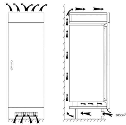
Rulla ut ledskyddet. På den sida av apparaten som saknar gångjärn trycker du in den mellan apparaten och insidan av skåpväggen (börja underifrån och arbeta uppåt).
