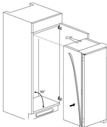
Åbn døren og skub siden af apparatet uden hængslerne mod siden af skabsvæggen. Fastgør apparatet to steder, 1) 2 torx-hovedskruer i den øverste sokkel øverst på apparatet og 2) 2 torx-skruer i fodderne (1 i hver fod) i bunden af apparatet.
