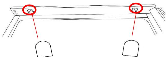
Bringen Sie eine Fußabdeckung an, indem Sie sie an den Füßen an der Unterseite des Geräts einklipsern. Der Kunststoffschacht an den Fußkappen dient als Richtlinie für den Abstand zwischen dem Produkt und der Kante des Schranks (ca. 42 mm). Brechen Sie den Kunststoffschacht nach der Installation ab.
