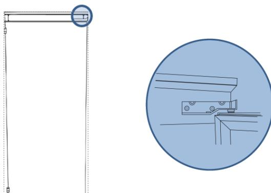
For at vende dørene skal du vippe apparatet bagud for at få fat i det nederste hængsel der holder skruerne. Vip ikke apparatet mere end 45 grader og læg ikke apparatet ned på siden.
