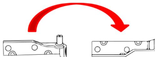
4. Vänd det övre gångjärnet 180° (så att stiftet pekar uppåt) och fäst det på motsatt sida i botten av apparaten. Sätt tillbaka dörren på det nedre gångjärnet.
