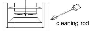
Forsigtig: Hold altid drænet over grøntsags- og frugtbakken klar for at sikre den normale strøm af afrimt vand. Brug stangen til at fjerne blokeringer.
