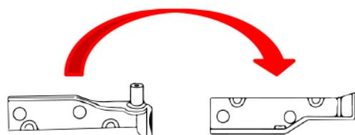
3. Entfernen Sie alle Schraubenabdeckungen auf der gegenüberliegenden Seite des Geräts, an der die Scharniere gerade entfernt wurden. Entfernen Sie die Scharnierstopfen an der Ober- und Unterseite der Tür und befestigen Sie sie auf der gegenüberliegenden Seite.
