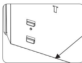
В долната част на задната плоча има две малки триъгълни релси. Поставете отоплителния уред на релсите и го бутнете към маншетите върху конзолата във вертикално положение.
