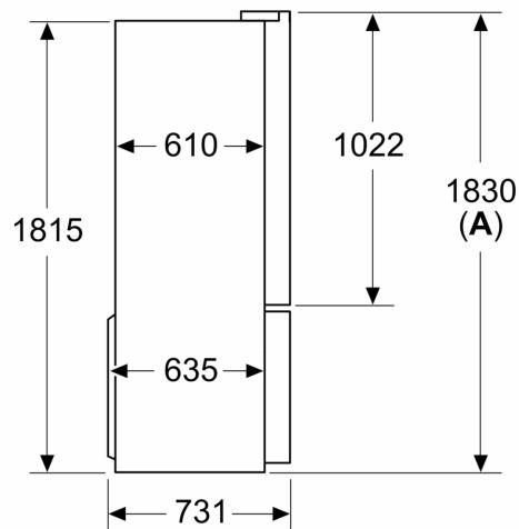
**A:** Fronten er justerbar 1830–1847 mm når justeringsføttene foran trekkes helt ut
