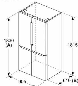
**A:** Fronten er justerbar 1830–1847 mm når justeringsføttene foran trekkes helt ut
