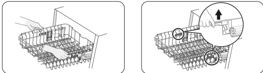
Um den Oberkorb anzuheben, heben Sie einfach den Oberkorb in der Mitte jeder Seite an, bis der Korb in der oberen Position einrastet. Es ist nicht notwendig, den Verstellgriff anzuheben.
