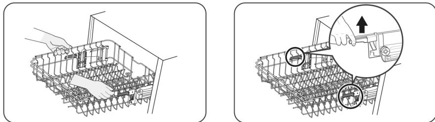
For at hæve den øvre kurv skal du bare løfte den kurven i midten af hver side, indtil kurven låses på plads i den øvre position. Det er ikke nødvendigt at løfte justeringshåndtaget.
