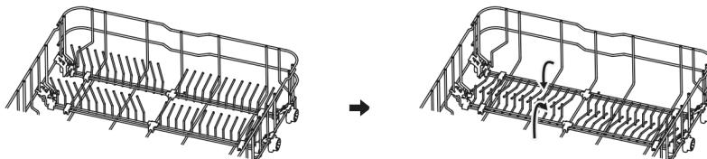
Piggene i den nedre kurv bruges til at holde tallerkener og fad. De kan sænkes for at give mere plads til store genstande.
