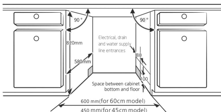
Hvis opvaskemaskinen sidder fast i hjørnet af kabinetet, skal der være plads, når døren åbnes.
