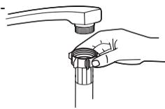
Wenn die Wasserleitungen neu sind oder für einen längeren Zeitraum nicht benutzt wurden, lassen Sie das Wasser laufen, um sicherzustellen, dass das Wasser klar ist. Diese Vorsichtsmaßnahme ist erforderlich, um zu vermeiden, dass der Wasserzulauf blockiert wird und das Gerät dadurch beschädigt wird.
