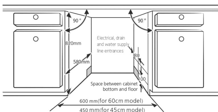
Om diskmaskin är installerad i hörnet av skåpet, bör det finnas lite utrymme när dörren öppnas.
