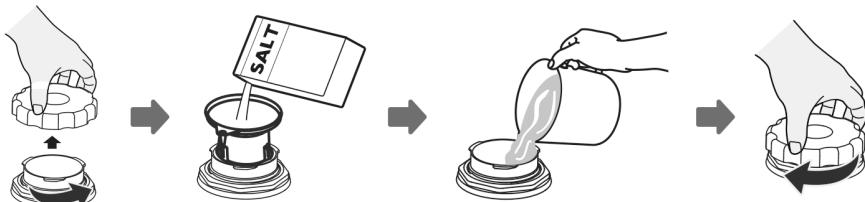
1 Entfernen Sie den unteren Korb und schrauben Sie den Deckel des Behälters ab.
