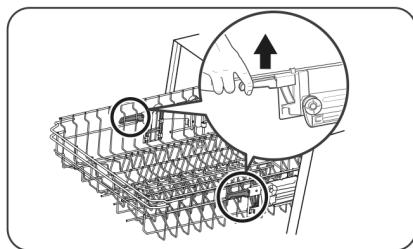
För att höja den övre korgen, lyft bara den övre korgen i mitten av varje sida tills korgen låses på plats i det övre läget. Det är inte nödvändigt att lyfta justeringshandtaget.
