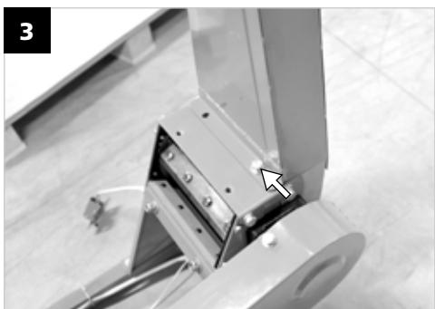
**HU** Hárrom csavarral szerelje fel a kidobócsatorna kéményét. Ne szerelje fel a csavart az ékszíj borításával szemben.
